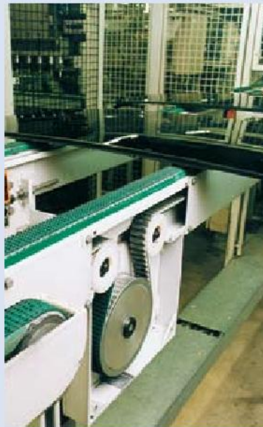
Транспортировка автостекол синхронно движущимися ремнями. Накладки на спинке ремня деликатно удерживают перемещаемый предмет и исключают проскальзывание.
