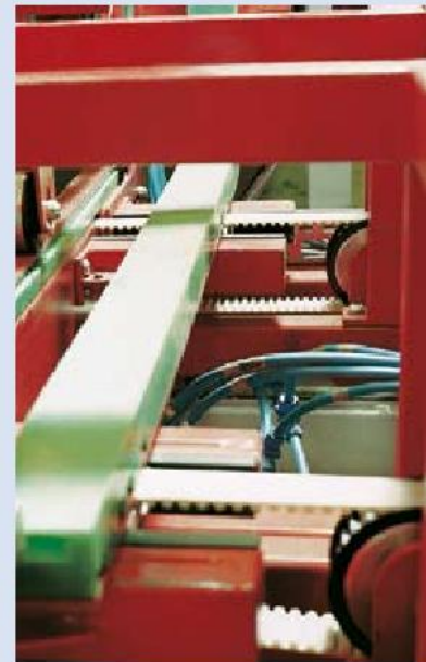
Транспортировка автостекол синхронно движущимися ремнями. Накладки на спинке ремня деликатно удерживают перемещаемый предмет и исключают проскальзывание.
